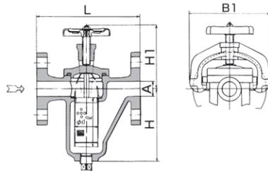
※工具を使用せずに簡単にカバーを取り外し、スクリーンの清掃が可能です。
