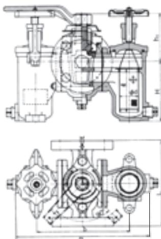
※工具を使用せずに簡単にカバーを取り外し、スクリーンの清掃が可能です。
